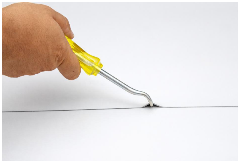
Slika 10. Prikaz ručne kontrole pomoću ispitivača vara [1]
