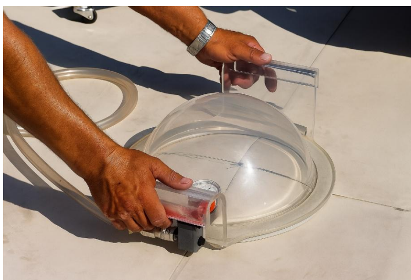
Slika 9. Prikaz ispitivanja membrane vakuuskom metodom [1]
