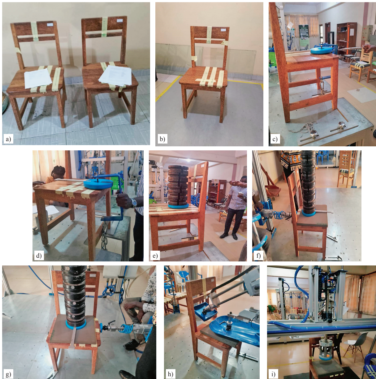
Figure 3 Experimental testing of coco wood chairs in accordance with EN standards: a) chairs in a climate-controlled room, b) chair at the marking-out centre, c) forward stability test, d) sideways stability test, e) rearward stability test, f) seat and back static load test, g) leg forward and sideways static load test, h) combined seat and back durability test, i) seat impact test Slika 3. Ispitivanje stolica od drva kokosove palme u skladu s EN normama: a) klimatiziranje, b) označivanje, c) ispitivanje stabilnosti prema naprijed, d) ispitivanje bočne stabilnosti, e) ispitivanje stabilnosti prema natrag, f) ispitivanje statičkog opterećenja sjedala i naslona za leđa, g) ispitivanje statičkog opterećenja nogu prema naprijed i bočno, h) kombinirano ispitivanje trajnosti sjedala i naslona za leđa, i) ispitivanje sjedala udarom
