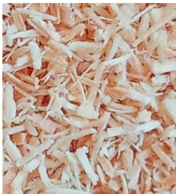
Figure 1 Micrograph (10x magnification) of P. pseudostrabus particles from the fraction retained on a 850 \mu\text{m} sieve Slika 1. Mikrografija (uz uvećanje od 10 puta) čestica drva P. pseudostrabus iz frakcije zadržane na situ od 850 \mu\text{m}
