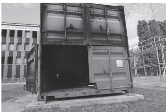
Figure 4. General view of the container fire simulator Slika 4. Opći prikaz simulatora požara kontejnera
