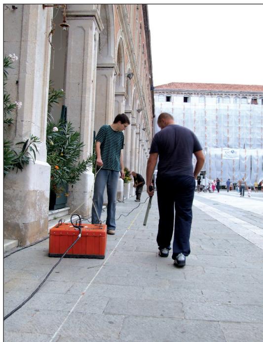
Sl. 18. Georadarsko istraživanje na Prokurativama antenom od 200 MHz
