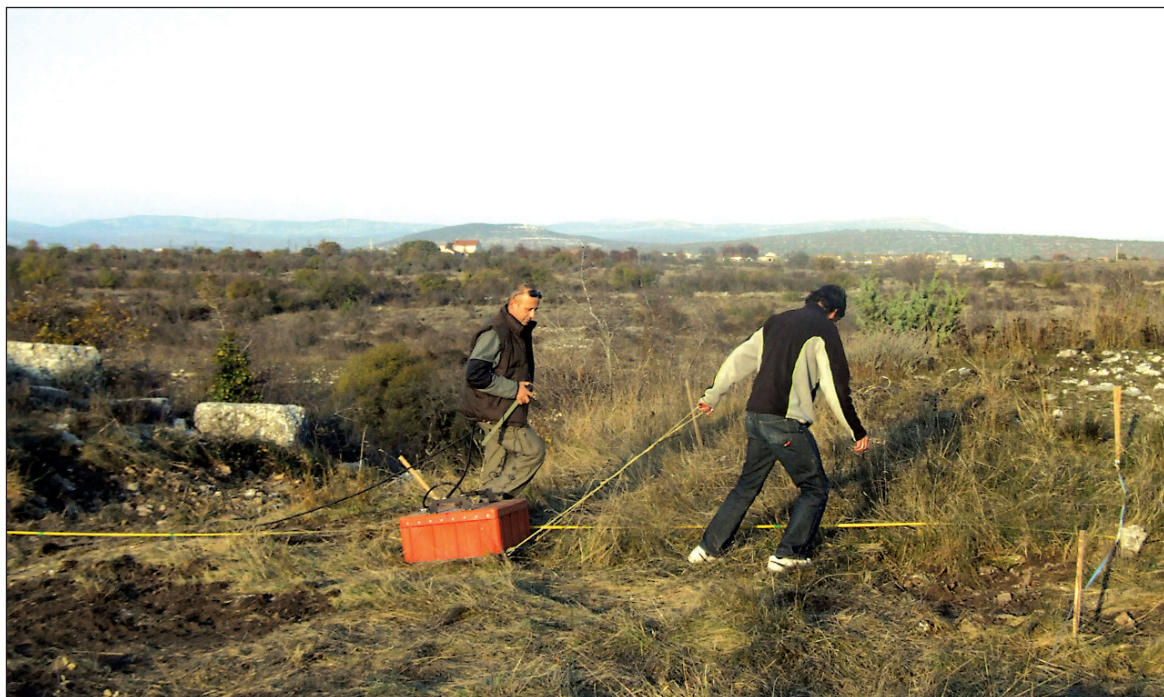
Sl. 2. Georadarsko mjerenje antenom od 200 MHz
