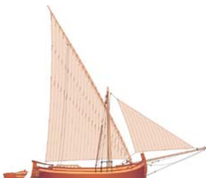
Opći plan tipične jadranske bracere s latinskim jedrom
