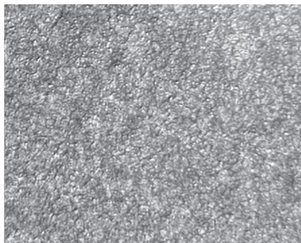
**Figure 3.** Microstructure of 42CrMo4 steel after the hardening and tempering (cross section of the sample, 250x magnification, etching: nital solution)**Slika 3.** Mikrostruktura čelika 42CrMo4 nakon kaljenja i popuštanja (poprečni presjek uzorka, povećanje 250x, nagrizanje: nital)
