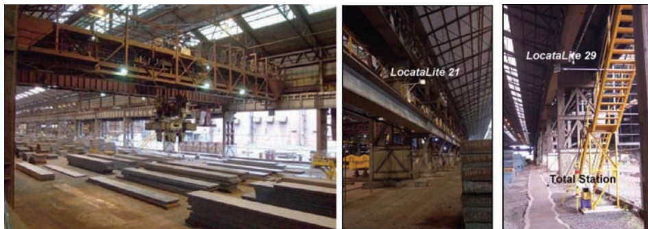
Slika 16. Pseudoliti u pozicioniranju tvorničke opreme i materijala (Barnes i dr. 2004b).
