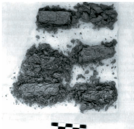
Sl. 69 - 70 Fotografija ulomaka keramike prije analiza te tijekom pečenja na 900^{\circ}\text{C} , prilikom koje dolazi do dezintegracije minerala gline (Gibson - Woods 1990, 198, fig. 156, 157).
