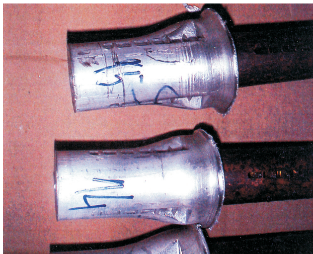
Figure 3 Samples welded by friction [7] Slika 3. Primjeri zavareni trenjem [7]
