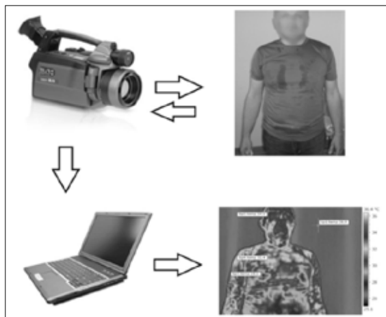
Slika 2. Načelo rada termovizijske kamere Figure 2. Operating principle of thermovision camera
