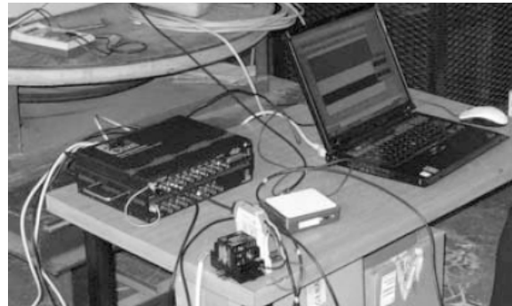
Slika 5. Prikupljanje podataka za analizu spektra statorske struje "Ex e" elektromotora
