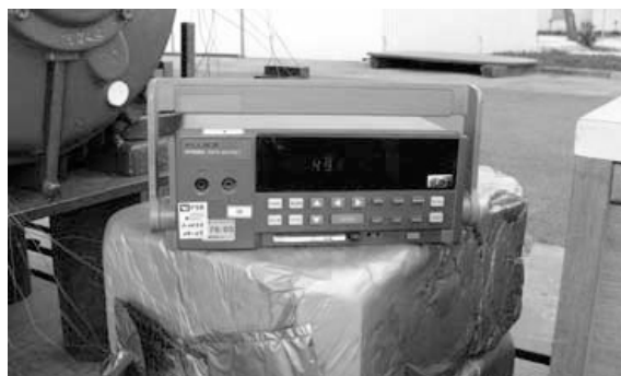
Slika 2. Instrumentarij za ispitivanje zagrijavanja elektromotora 47 kW, "Ex e"
