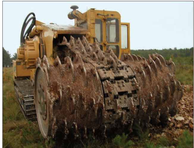
Slika 1. Pokretna drobilica kamena Vermeer T 855 Figure 1 Terrain leveler Vermeer T 855
