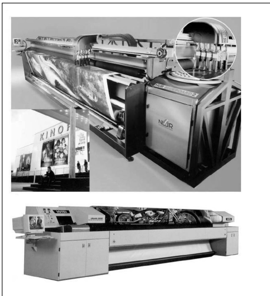
Sl. 21. Veliki inkjet stroj širine 5 m, s piezo tehnologijom, VUTEK.
