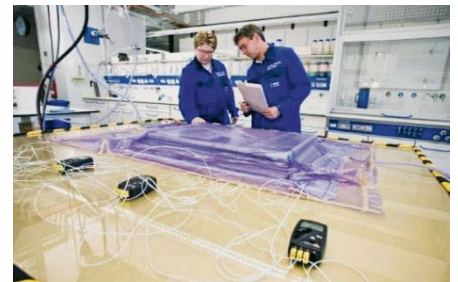
SLIKA 11 - Veliki stol s grijačima za simuliranje realnih uvjeta proizvodnje
