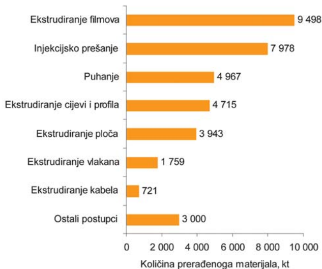
SLIKA 9 - Količina plastomera prerađenih pojedinim postupkom u Europi u 2009.
