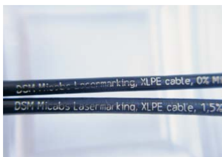
SLIKA 12 - Natpis na kabelima načinjen laserskim zračenjem
