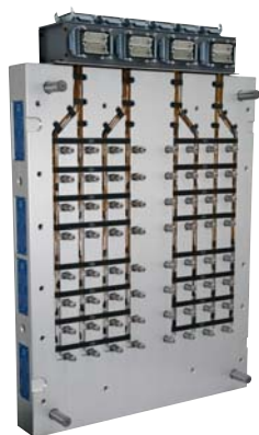
SLIKA 16 - Nepomični dio kalupa sa 64 kalupne šupljine i sustavom QUICK-FLO™
