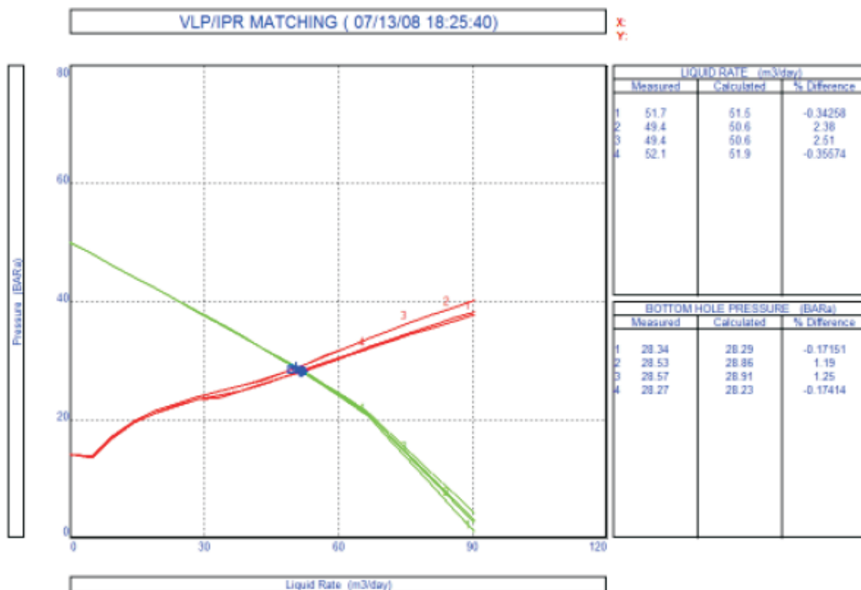
Slika 7. Dijagram presjecišta VLP i IPR krivulja (Korenjak 2008) Figure 7 Diagram of VLP/IPR matching (Korenjak 2008)
