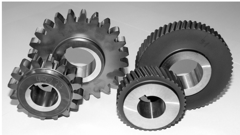
Slika 13: Geometrija standardnog zupčanika i zupčanika s malim gubicima
