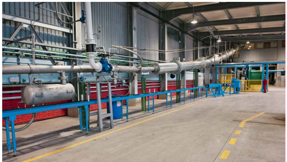
Novi Elkina linija za proizvodnju srednjonaponskih (SN) i visokonaponskih (VN) energijskih kabela
