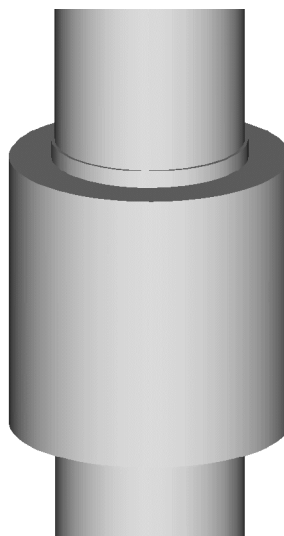
Slika 14. Detalj CAD modela ležaja struka kormila
