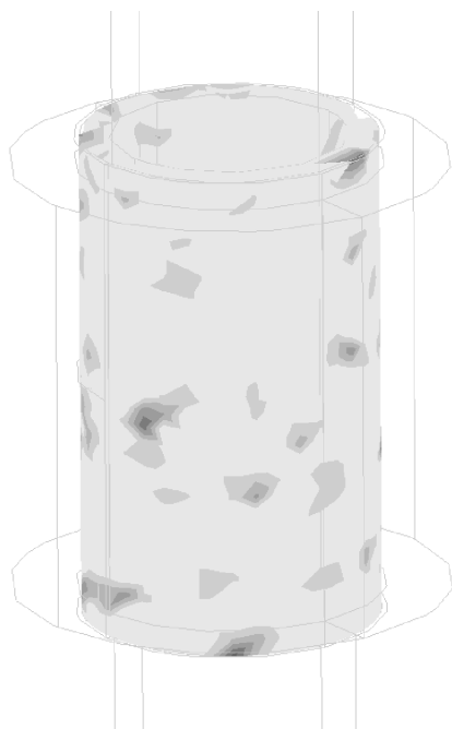
Slika 13. Kontaktni pritisci u ležaju struka kormila
