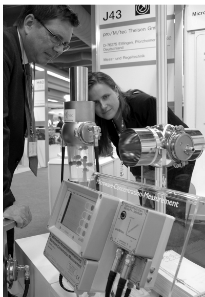
Slika 10 – Kontinuirano (in-line) mjerenje koncentracije pomoću mikrovalova
