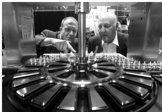
Slika 8 – Kontrolna vaga za četverokratno doziranje aerosola
