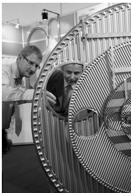
Slika 4 – Pločasti čelični izmjenjivač topline
