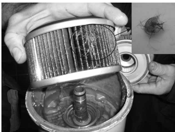
Slika 5. Nečistoća na standardnom filtru goriva i vlakanca koja su onemogućila protok goriva kroz uređaj za mjerenje
