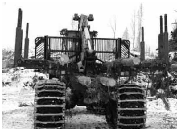
Slika 8. Opcija tovarnoga prostora LoadFlex Bio
