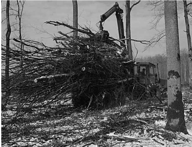
Slika 9. Izvoženje šumskoga ostatka forvarderom
