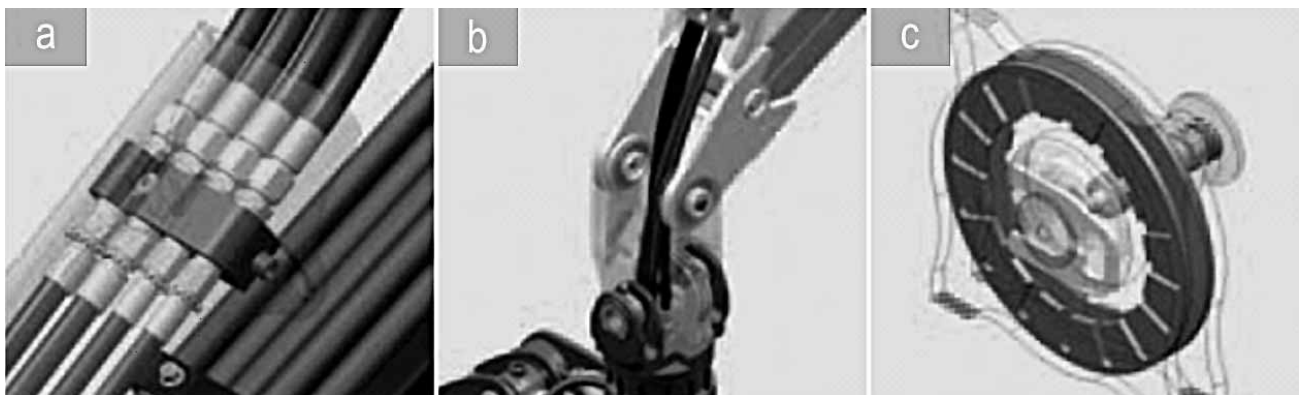
Slika 10. Nova tehnološka rješenja sustava ProTec u vođenju cijevi i prigušenju njihanja hvatala
