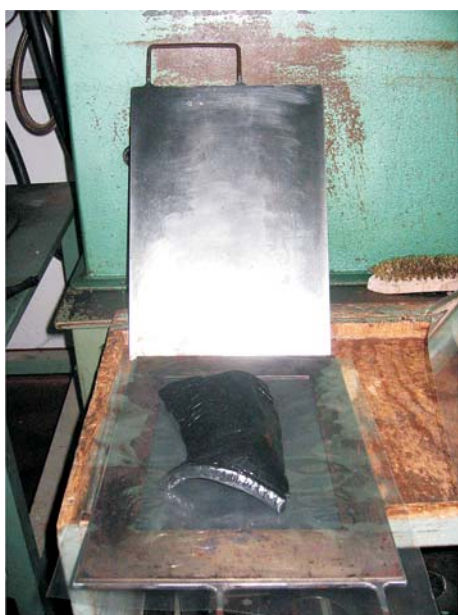
Figure 3 Rubber compound in the mould Slika 3. Kaučukova smjesa uložena u kalup
