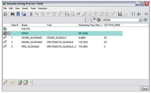
Figure 8 Total machining time of the casting panel and individual time in a technological sequence Slika 8. Ukupno vrijeme izrade ljevačkog panela i pojedinačno vrijeme u tehnološkom nizu
