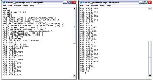
Figure 7 The presented part of the G-code of the direct steering file Slika 7. Predstavljeni dio G-koda direktne upravljačke datoteke
