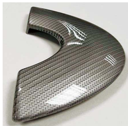
SLIKA 11 – Otpresak od PUR-ABS-a, folija, ABS-nosač, PUR-pokrovni sloj
