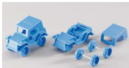
SLIKA 3 – Arburgov buggy - polimerni proizvod s metalnim umetcima
