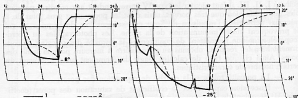
Fig. 1. Variations et températures dans les deux chambre froides pendant les expériences 1 = température de l'air 2 = température à cœur d'un bloc de pierre de Caen de 1,5 kg (porosité = 20%)
