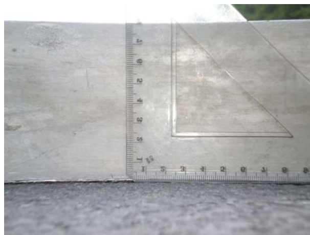
Slika 11. Detalj mjerenja dubine kolotruga (19. 5. 2009.) na km 8+100 (smjer Županja - Vinkovci)
