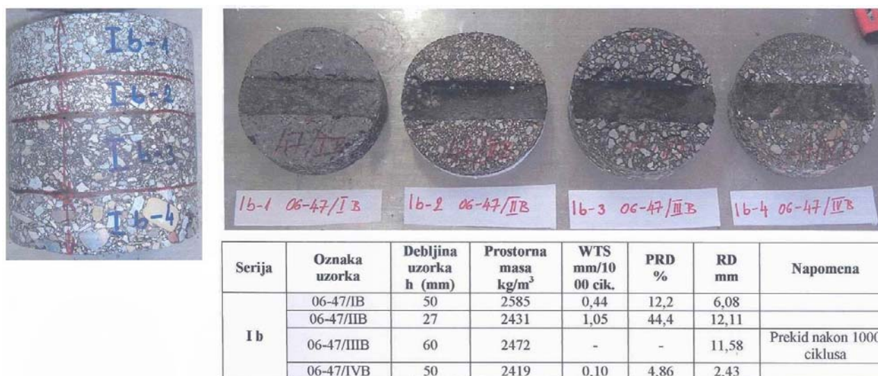
Slika 5. Rezultat jednog od uzoraka ispitivanja otpornosti na trajnu deformaciju
