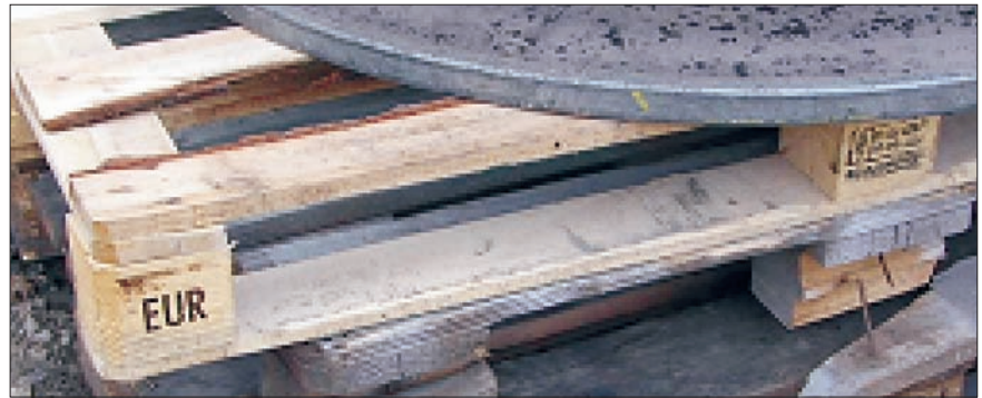
Slika 9. EUR paleta sa značajnom količinom kore Figure 9 EUR palette with significant amount of bark
