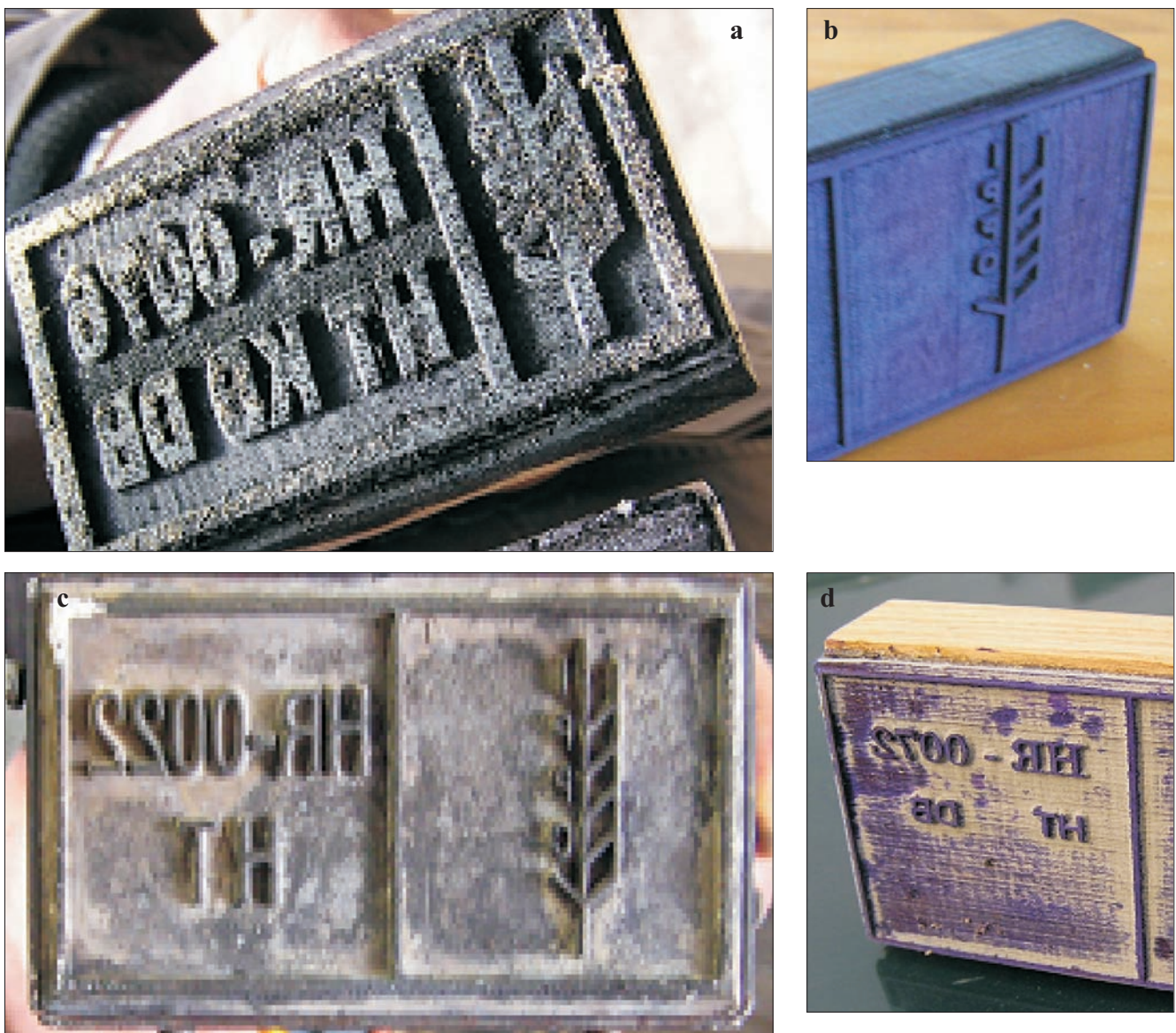
Slika 6. Neadekvatne oznake na žigovima: a) tvrtka nema ovlaštenje za provođenje KD postupka, već samo HT, b) umjesto oznake IPPC na žigu je oznaka IPPO, c) na žigu je samo oznaka HT, a potrebno je HT DB, d) oznake su neadekvatne veličine.
