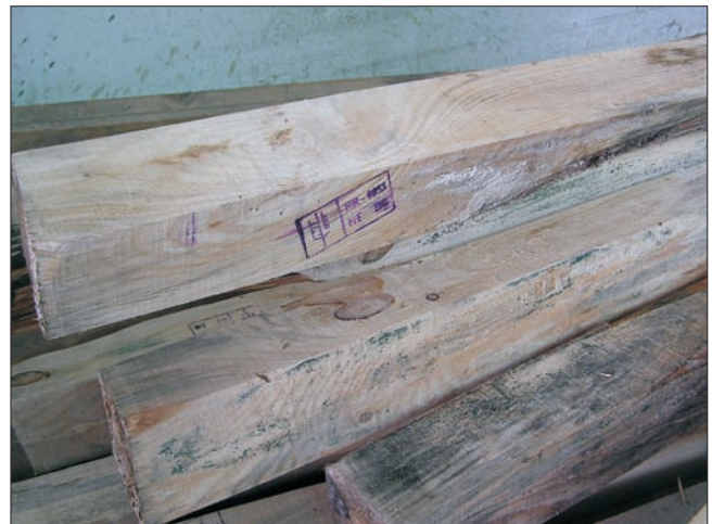
Slika 10. Posljedice neadekvatnog skladištenja tretiranog drvenog materijala za ambalažu
