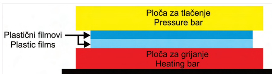
Slika 6. Presjek stvaranja oštećenja između dva plastična filma upotrebom wolframove niti
