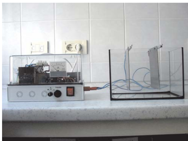
Slika 1. Uređaj za proizvodnju istosmjerne struje s „elektrolizerom“
