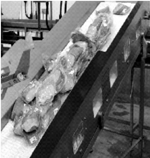
Slika 7 – Namirnica u plastičnoj vakuumskoj ambalaži prije obrade visokim tlakovima 5
