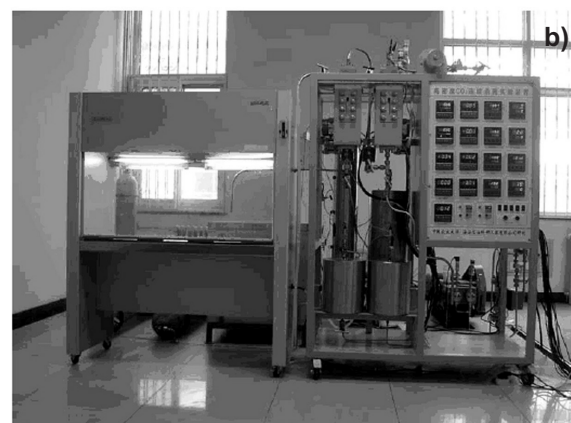
Slika 2 – Postrojenje za obradu hrane visokim tlakovima u diskontinuiranom postupku (a) 5 i kontinuiranom postupku (b) 5
