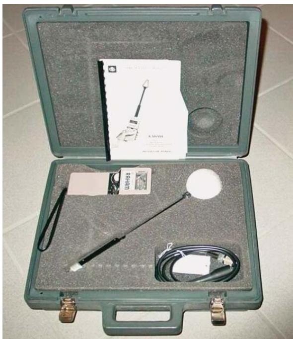
Slika 2 Terenski uređaj za mjerenje usrednjene izračene snage neionizirajućeg EM zračenja u mikrovalnom području RAHAM.
