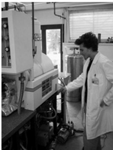
Slika 1 – Spektrometar masa ionsko ciklotronske rezonancije uz Fourierovu transformaciju Extrell FTMS 2001 DD (Laboratorij za kemijsku kinetiku i atmosfersku kemiju, Institut Ruđer Bošković)
