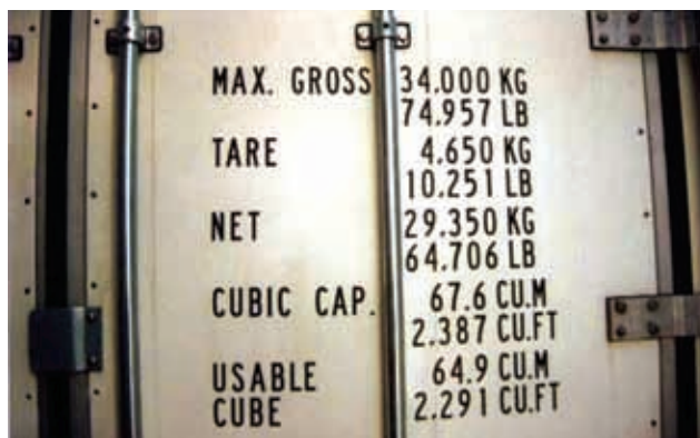
Slika 3. Karakteristični podaci na vratima kontejnera TLC TL-96 Figure 3. Characteristic data on the door of the container TLC TL-96
