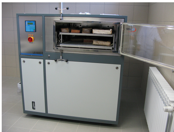
Slika 3. Komora za liofilizaciju LIO 8000 kojom je opremljen Centar za spašavanje arhivskoga gradiva HDA. Dimenzije komore su: 730 x 220 x 775 mm.
