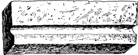
Sl. 84. Ploča sa žlijebom iz poda jedne rimske zgrade. Iz Siska. Po prilici. \frac{1}{40} nar. vel.
