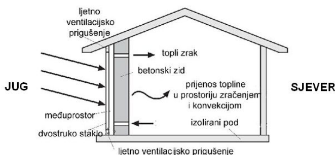
Slika 9 - Trombov zid
