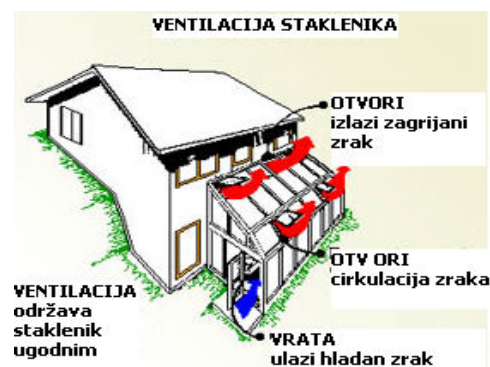
Slika 14 - Prikaz funkcioniranja ventilacije staklenika
