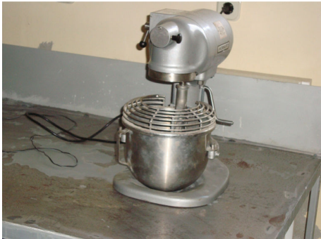
Slika 2 - Miješalica za spravljanje mješavina morta
