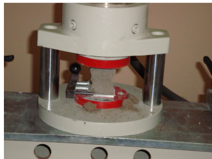
Slika 8 - Ispitivanje tlačne čvrstoće morta
