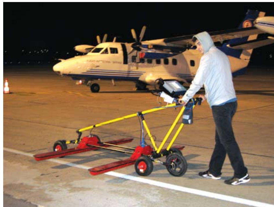
Slika 2: Detekcija krških formacija (kaverni) ispod piste i stajanke aerodroma Čilipi pored Dubrovnika bistatičkim antenskim sustavom na frekvenciji od 40MHz na dubinama većim od 10m, listopad 2008
