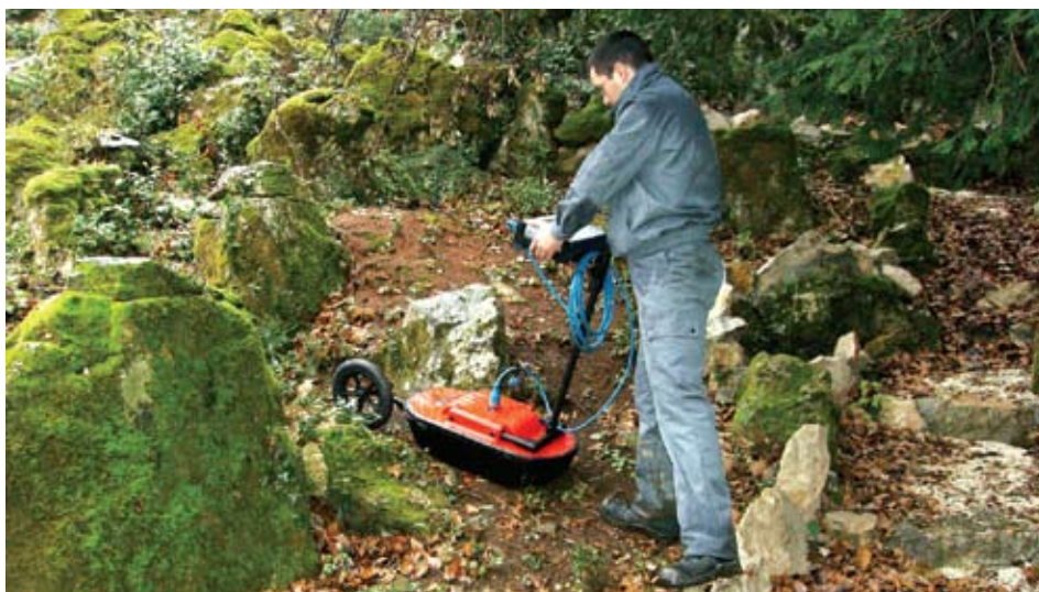
Slika 5. Detekcija dubine okršavanja GPR sustavom na frekvenciji od 350 MHz, Mošćenička Draga, svibanj 2008
