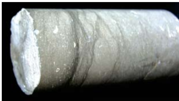
Sl. 6. Polirani uzorak jezgre iz bušotine (s prijelomom „naživo“)
