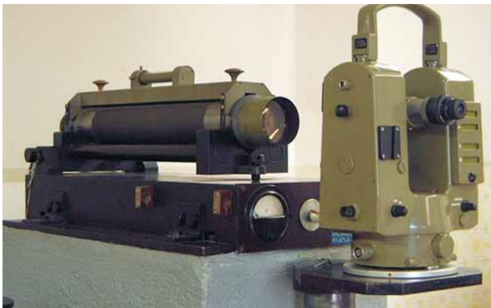
The system consisted of two collimators for examination and rectification of collimation error Sustav od dva kolimatora u pravcu, za ispitivanje i rektifikaciju kolimacijske pogreške
