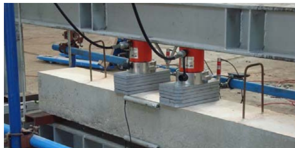
Slika 8. Mjerenje deformacija u srednjem presjeku grede pri unosu opterećenja
