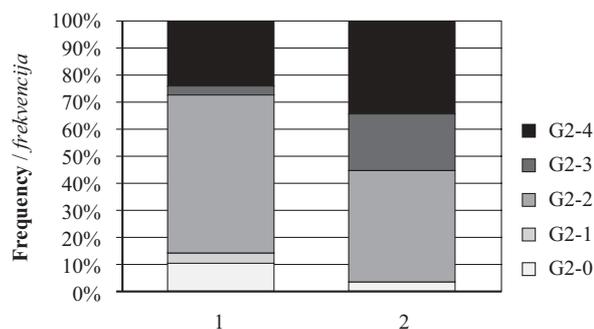
**Figure 8** Frequency distribution of graded spruce sawnwood before (1) and after drying (2) by procedure 3. **Slika 7.** Distribucija frekvencija klasa kvalitete piljenica prije sušenja (1) i nakon sušenja (2) pri 3. režimu sušenja
