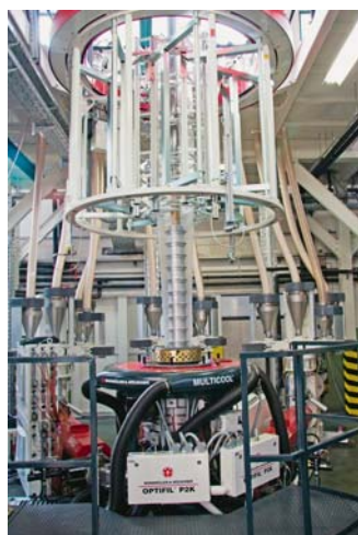
Novi troslojni ekstruder pušten u rad u Muraplastu
