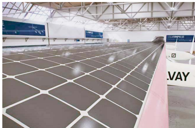
SLIKA 4 –Solarne ćelije koje drže ekstra debele akrilatne ljepljive trake
