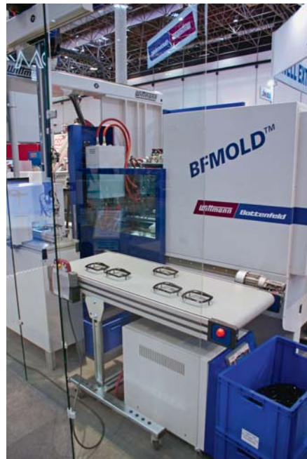
SLIKA 12 – Proizvodnja okvira navigacijskog uređaja visokog sjaja BFMOLD™ postupkom (Foto: M. Katalenić)
