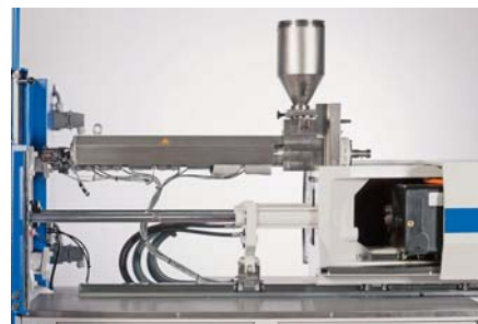
SLIKA 10 – Sustav KERS na električnoj ubrizgavalici Wittmann Battenfeld (Foto: Wittmann Battenfeld)
