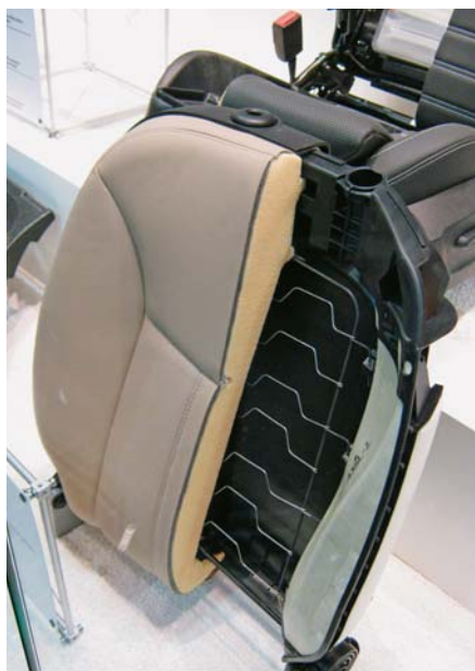
SLIKA 19 – Lagana kompozitna automobilska sjedalice tvrtki BASF i Faurecije (Foto: M. Rujnić-Sokele)
