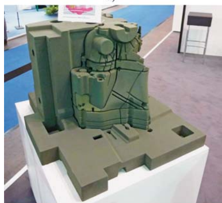
SLIKA 4 – ProMetalov postupak izrade pješčanih kalupa i jezgri (Foto: A. Pilipović)
