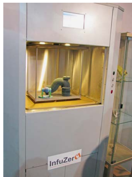
SLIKA 2 – InfuZer CI – završna obrada tvorevina nastalih 3D tiskanjem (Foto: D. Godec)
