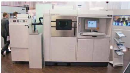
SLIKA 12 – EOS M280 – stroj za selektivno lasersko taljenje metala (Foto: B. Valentan)
